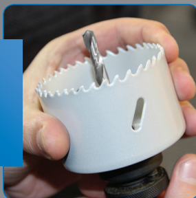
1. BEFESTIGUNG DER LOCHSÄGE AUF DEM AUFNAHMEGEWINDE
